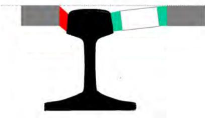
**Fuge:** Schnittstelle zwischen Schiene und angrenzender geschlossener Oberfläche
